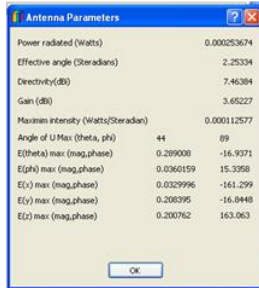
Fig.9: Antenna Parameters for 2.45 GHz
